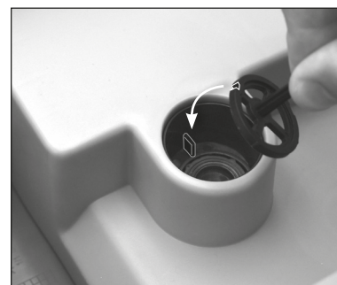
3. Réinsérer l'ouvre-valve et le microfiltre s'assurant de les placer correctement dans la rainure.
