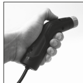
4. Trzymać wciśniętą dźwignię pistoletu, aż woda przestanie wypływać.
